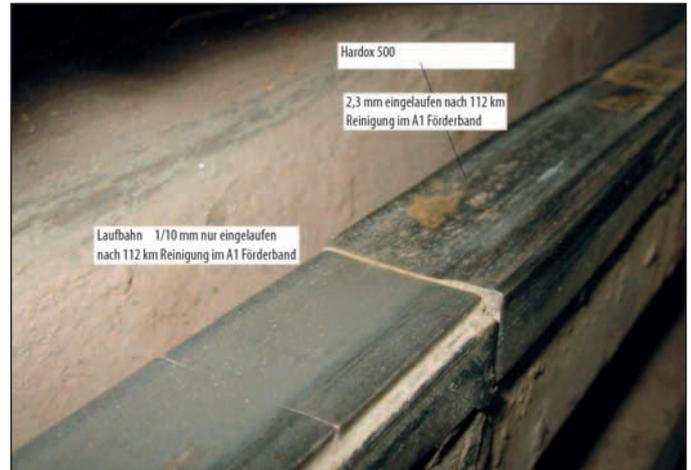
Abb. 8: Gegenüberstellung Hartmetalleisten – Leisten aus Hardox 500
