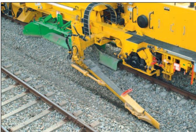
Abb. 9: Planier- und Flankenpflug der Schotterverteiler- und Planiermaschinen SSP 110 SW
