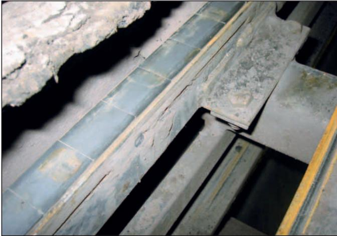
Abb. 7: Hartmetalleisten für Rollenlaufbahnen von Förderbändern
