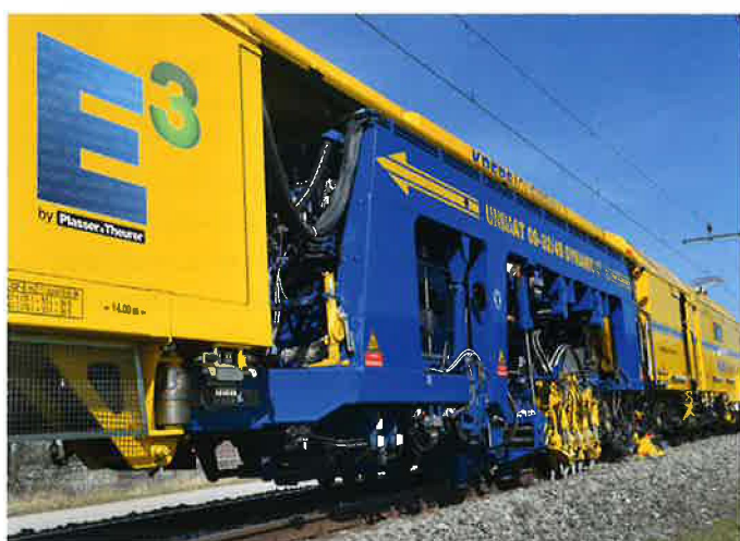
Die Universalstopfmaschine Unimat 09-32/45 Dynamic E 3 arbeitet bei Krebs Gleisbau zu mehr als 90 Prozent elektrisch.
