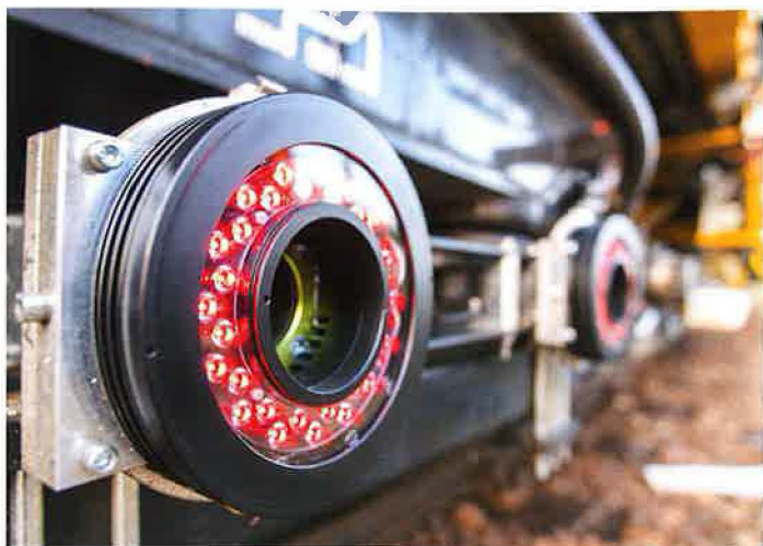
Links: Stereo-Kamerasystem von PlasserReferencedTrackGeometry mit Hochgeschwindigkeitskameras und Infrarot-Ringlichtern, das beidseitig am Drehgestell angeordnet ist. Rechts: Ultrareflektierender Referenzmarker an einem Festpunkt der Strecke.
