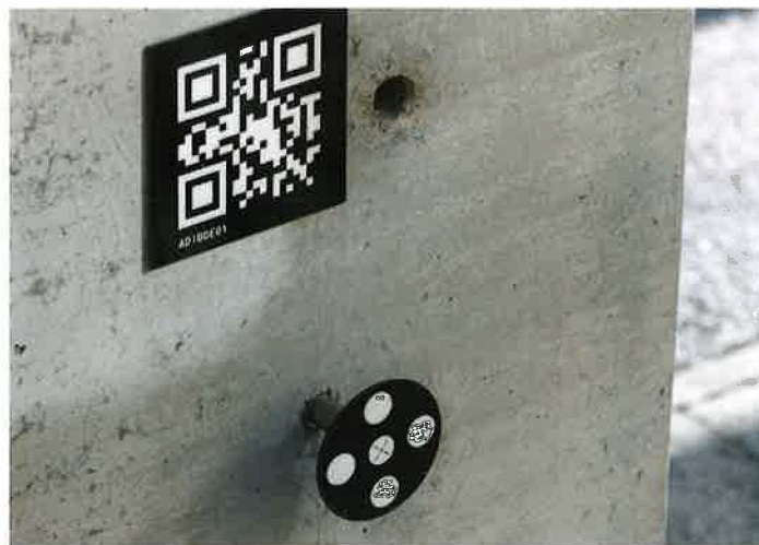
Links: Stereo-Kamerasystem von PlasserReferencedTrackGeometry mit Hochgeschwindigkeitskameras und Infrarot-Ringlichtern, das beidseitig am Drehgestell angeordnet ist. Rechts: Ultrareflektierender Referenzmarker an einem Festpunkt der Strecke.
