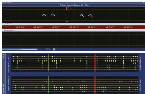
Bild 13: Beispiel B-Scan und Stripchart einer Ultraschallprüfung
