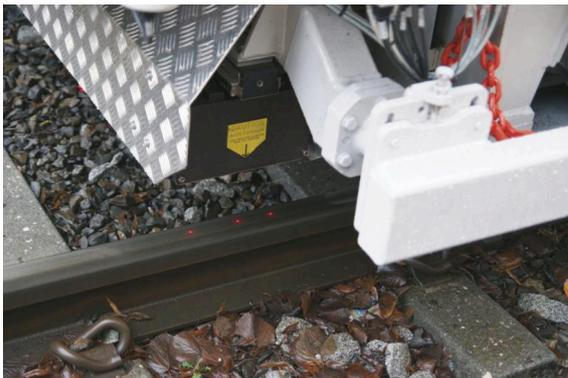
Bild 6: Beispiel Sensorkopf Fahrzeuggebundene Längsprofilmessung
