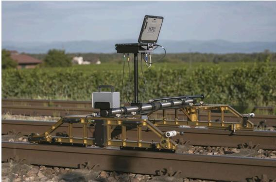
Bild 4: Taktiles Längsprofilmessgerät vom Typ RMF 1100
