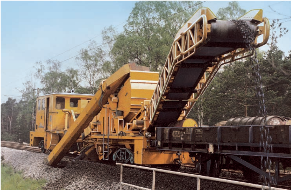
Bedarf für gleisgebundene Reinigung des Schotterbetts früh erkannt: 1963 nahm die erste vollhydraulische Bettungsreinigungsmaschine den Betrieb auf.
