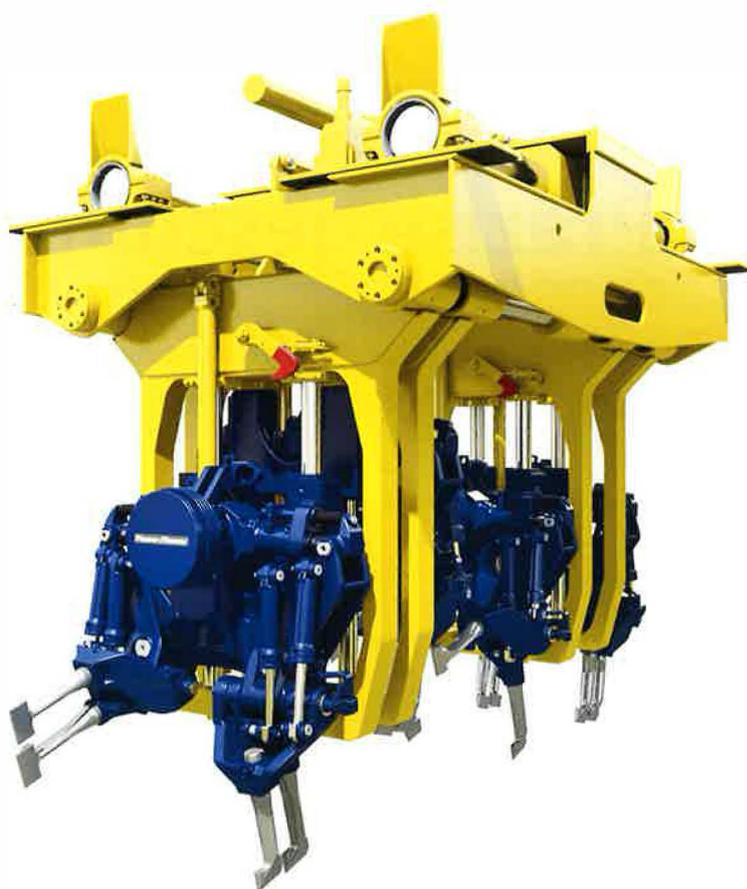
So im wahren Leben nie zu sehen: Stopfeinheiten, hier ohne Hydraulikleitungen und Elektrokabel, können komplett getauscht werden. Alle mechanischen Anschlüsse passen.
