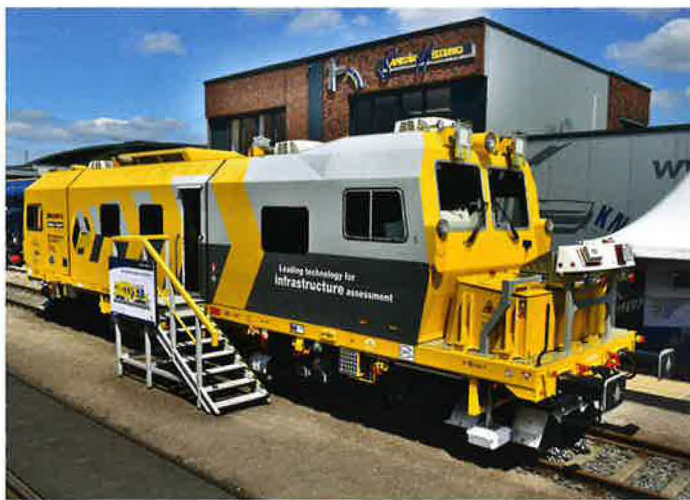
Links: Die Datenaufnahme der EM VT kann durch Drohnenflüge mit „Monitoring Eye“ ergänzt werden, sodass am Rechner ein dreidimensionales Abbild der Strecke entsteht. Rechts: Der EM120VT hatte auf der iaf 2022 in Münster Premiere.
