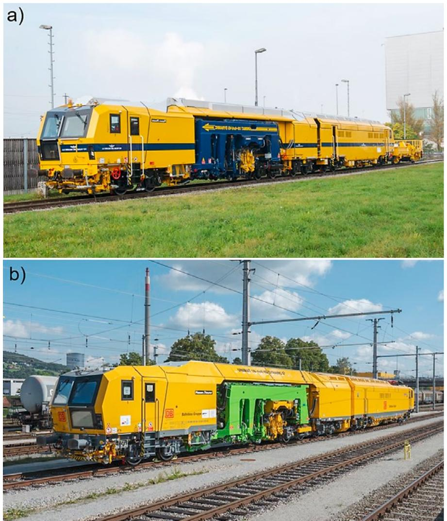
1: Die beiden gemessenen Maschinen: a) Unimat 09-4x4/4S Dynamic (dieselhydraulisch); b) Unimat 09-4x4/4S Dynamic E<sup>3</sup> (Hybridantrieb: vollelektrischer und dieselelektrischer Antrieb)
