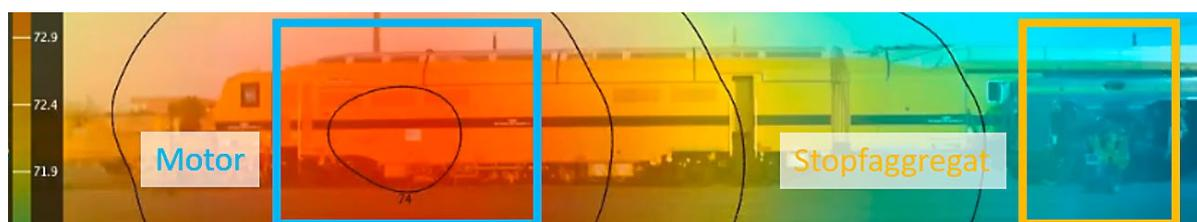
**3:** Ausschnitt der Messung mit der Schallkamera (dieselhydraulischer Antrieb). Der Dieselmotor (roter Bereich) kann deutlich als die dominante Lärmquelle identifiziert werden. Die Emission des Stopfaggregats ist deutlich niedriger (blauer Bereich)
