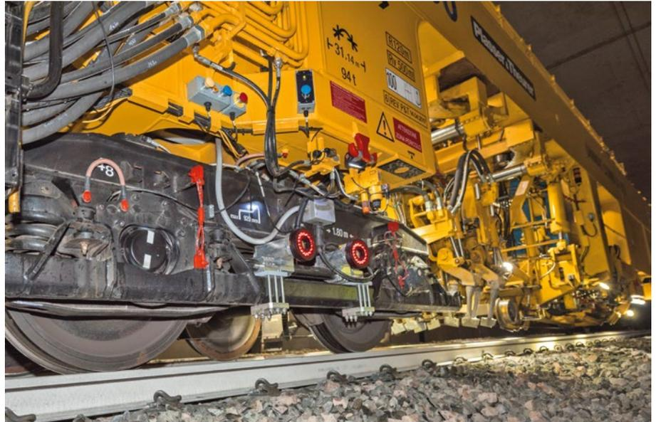
2: RTG-System aufgebaut auf einer Plasser & Theurer Stopfmaschine
