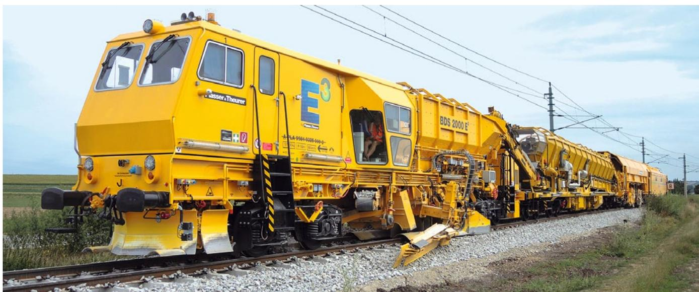
**Abb. 3:** Schotterverteiler- und Planiermaschine BDS 2000 E<sup>3</sup> im Arbeitseinsatz
