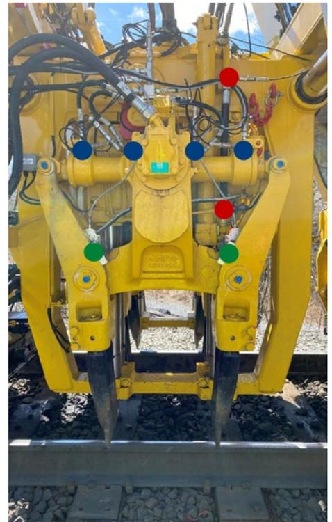
**Abb. 1:** Gleisstopfmaschine GRM 3000 (links) und das Stopfaggregat mit der genauen Position der für die Datenerfassung verwendeten Sensoren – Drucksensoren am Beistellzylinder (blau), Drucksensoren am Hebe- und Senkzylinder (rot) und Winkelsensoren (grün) (rechts) *Quelle: B. Antony*
