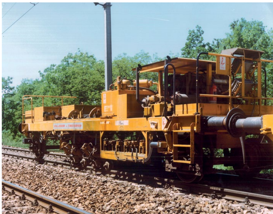
Abb. 2: Der erste Dynamische Gleisstabilisator. Das Stabilisierungsaggregat wurde auf einem Hänger aufgebaut.
