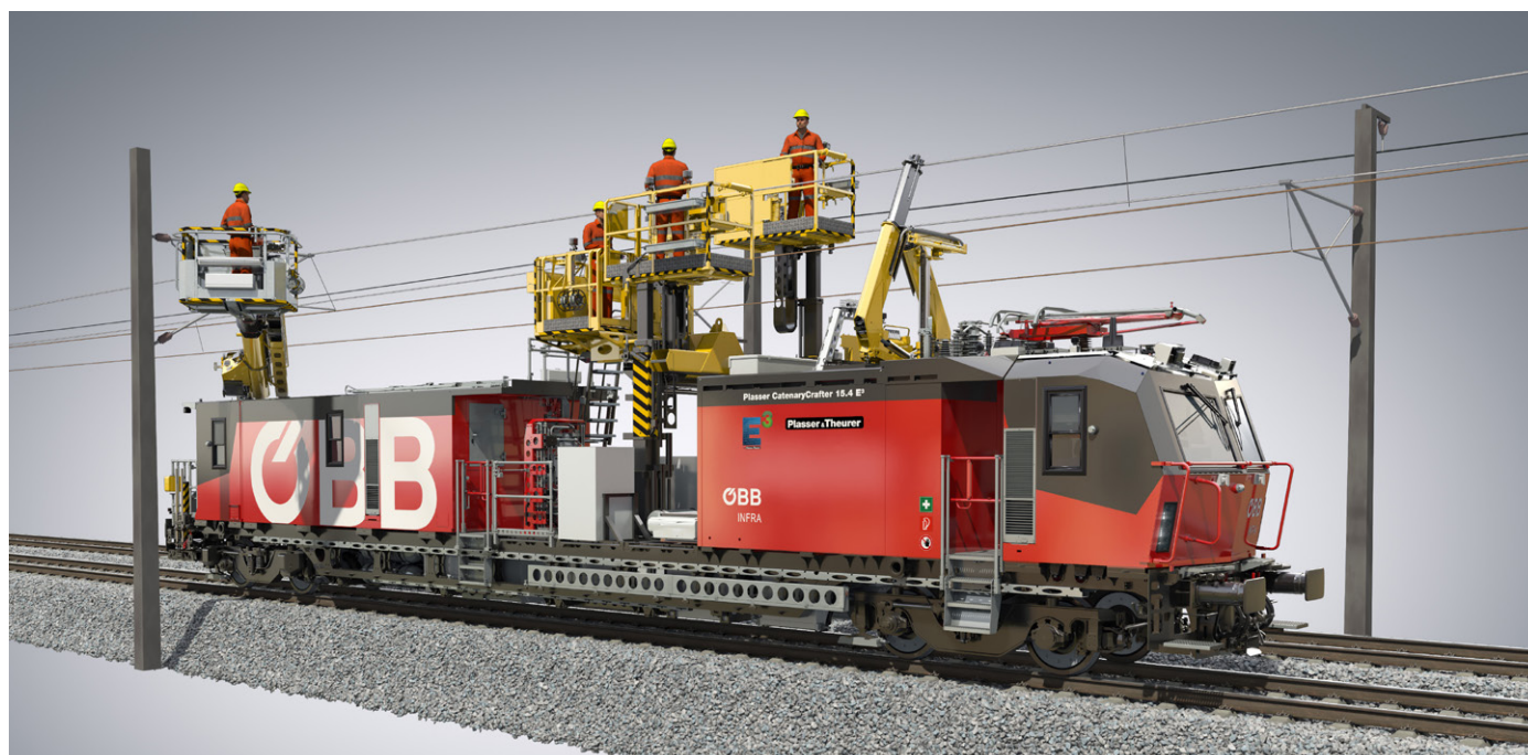
Bild 1: Der Plasser CatenaryCrafter 15.4 E 3 (Typ 1) für Montageleistungen rund um Oberleitungen
