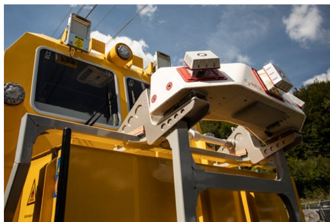
Abb. 3: Detailansicht der Scaneinrichtung an der Fahrzeugfront des EM120VT
