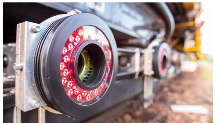
Abb. 7: Das integrierte Messsystem nimmt die Gleisgeometrie samt Referenzpunkten auf.
