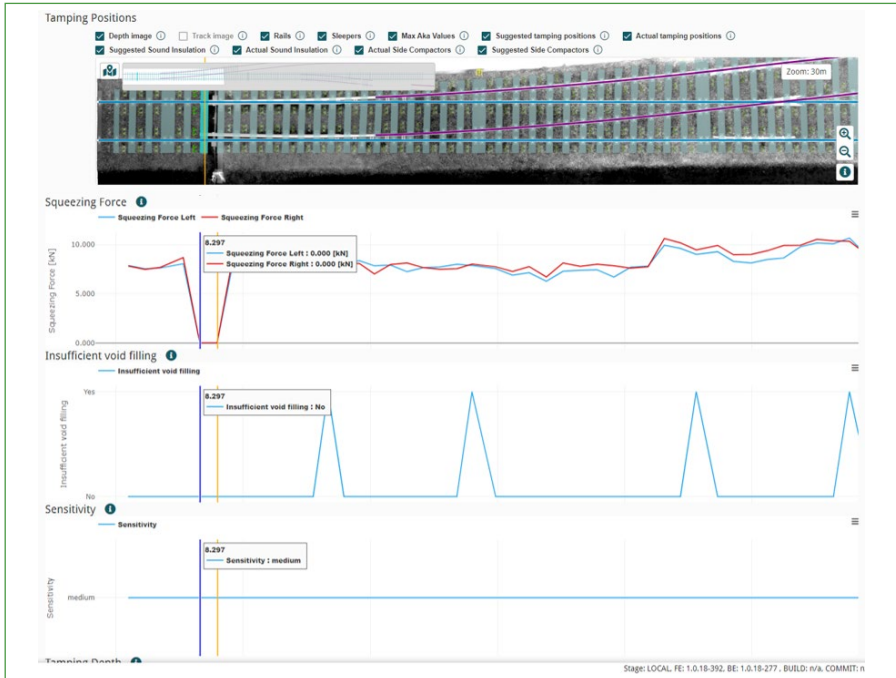
Abb. 12: Bedienfenster der Plasser TampingControl einer 1-Schwellen-Stopfmaschine (a), Darstellung ausgewählter Kenngrößen im Plasser TampingReport (b)
