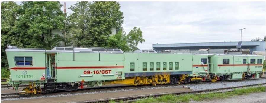
Abb. 4: Gleisstopfmaschine 09-16/CST, ausgerüstet mit dem Messsystem
