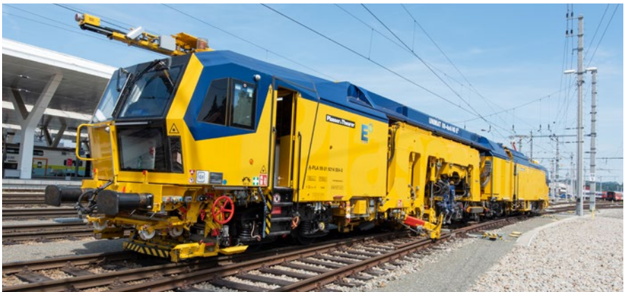
Abb. 9: Stopfmaschine ausgestattet mit Plasser TampingAssistant
