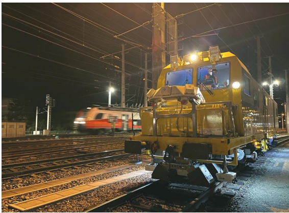
Bild 9: Stereo-Kamerasystem von Plasser ReferencedTrackGeometry mit Hochgeschwindigkeitskameras und Infrarot-Ringlichtern, das beidseitig am Drehgestell angeordnet ist
