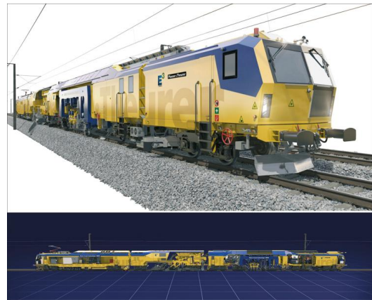
Bild 8: Unimat 09-8x4/4S BR-Dynamic E 3 , oben: Stirnansicht, unten: Seitenansicht mit Blick auf den hybriden Antriebsstrang, die Planier- und Profiliereinheit, das 8x4 Stopfaggregat und den
