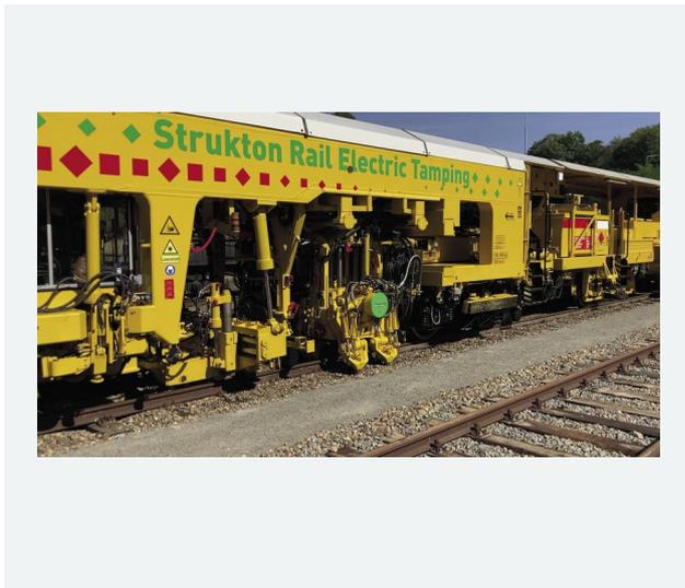
Bild 5: Strukton stopft elektrisch, hier mit dem Öko-Retrofit am Testgelände in Holland
